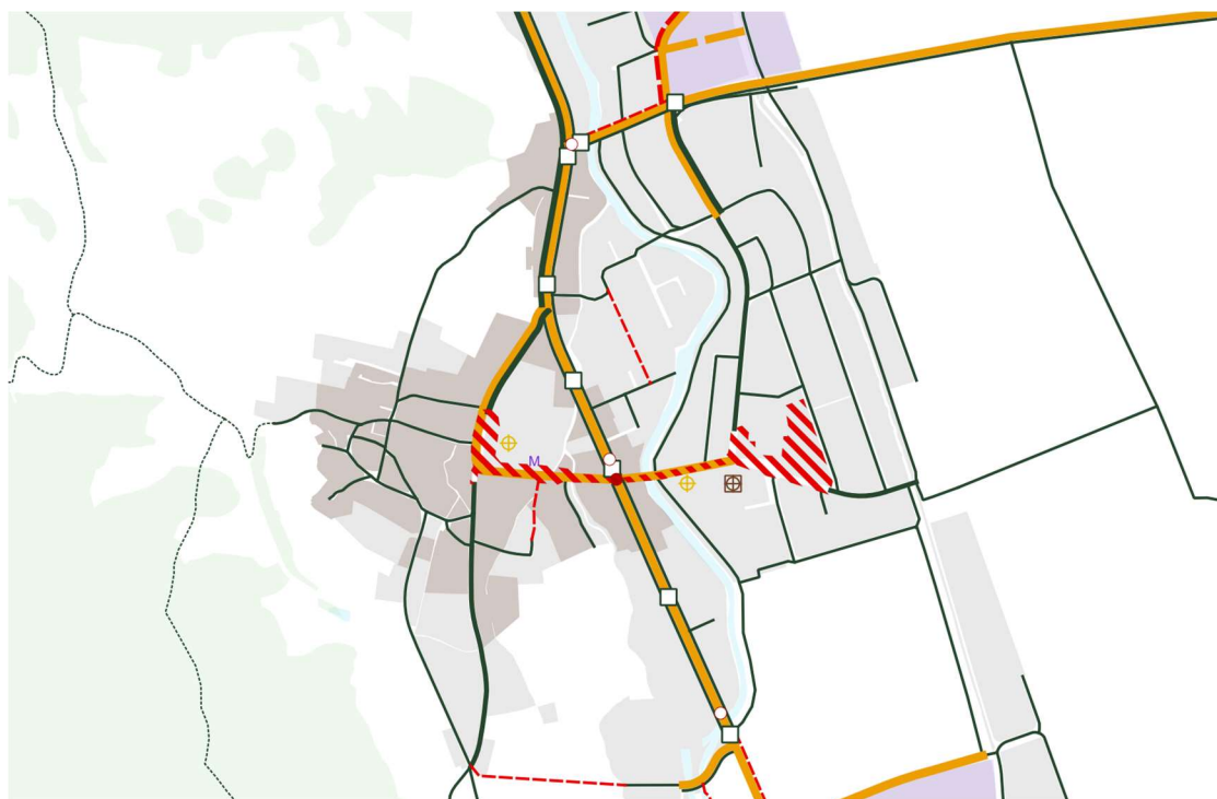
Abbildung 8: Konzeption der Fussverkehrsnetze am Beispiel Oberurnen. An zentraler Lage in der Ortschaft (z.B. Quartierzentrum, bedeutendes Ziel) wird ein Begegnungsbereich definiert. Das Fusswegnetz in die Quartiere soll möglichst dicht sein. Wichtige Fussverbindungen werden als Haupttrouten ausgezeichnet.
