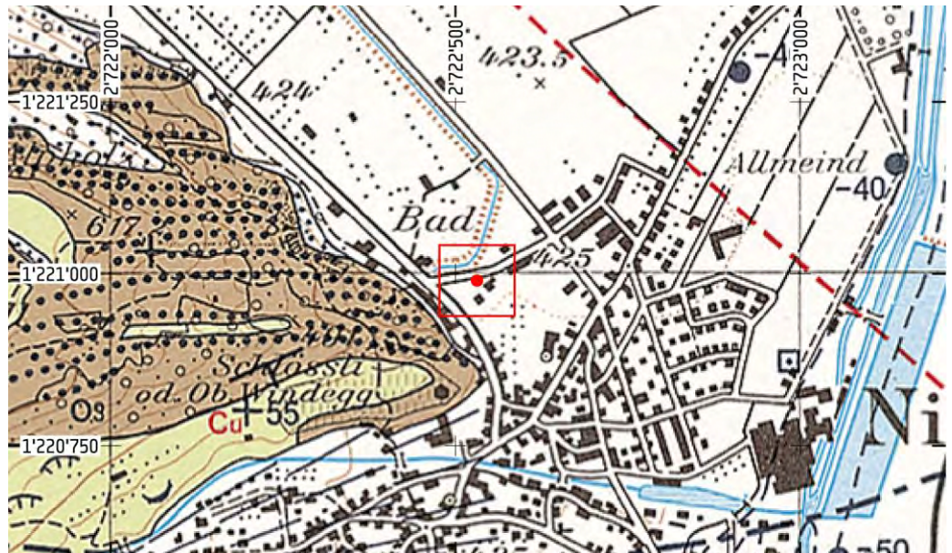
Abb. 2: Auszug aus der geologischen Karte 1:10'000 [1] mit der Lage der Bauparzelle (rot). Weiss: Alluvionen, Hellgrün: Linth- Rheingletscher Moräne, Braun: Kalksteine und Mergel der Unteren Süsswassermolasse (USM).
